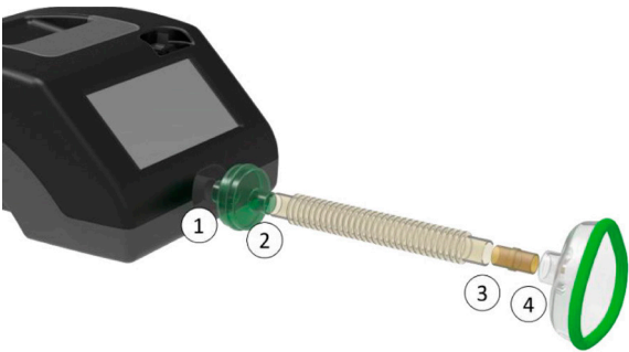
Figura 17 - Montaje del circuito del paciente con espacio muerto.
